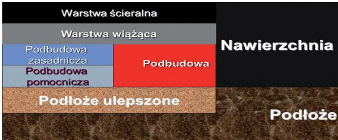
Rys. 3 Warstwy konstrukcyjne nawierzchni asfaltowych [11]
