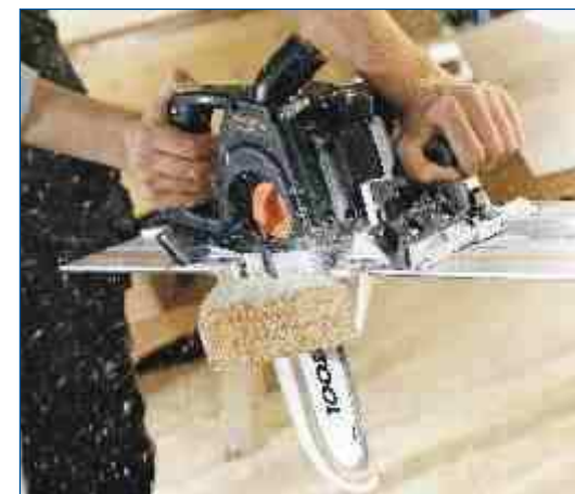
Rys.: Protool frezarka siodłowa NRP 90 (na lewo) i pilarka łańcuchowa SSP 200 (na prawo).
