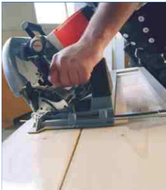
Rys.: Pilarki Mafell z precyzyjną skalą kątową
